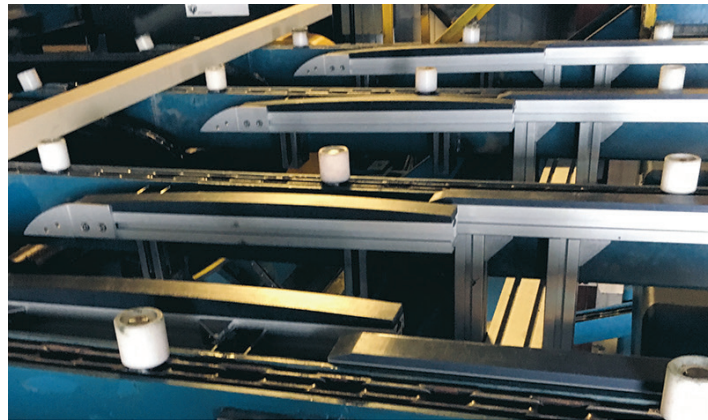
Densigrader och Weighter är system framtagna för att kostnadseffektivt mäta densitet respektive vikt bl a för att ge virket en fuktclass inför torkning i en virkestork.
