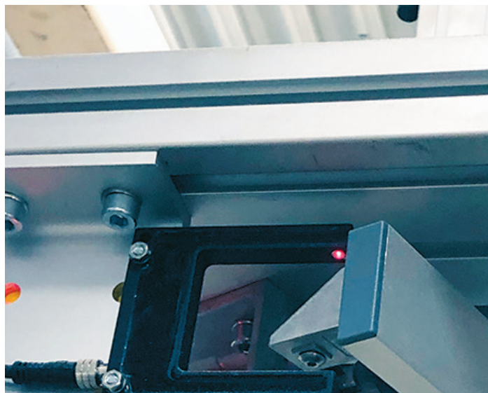
En hammare före kapsågen knackar på träbitarna för att mäta hållfastheten. Här en närbild på en av två Dynagrade som sitter före och efter hyvellinjen i Nydala.
