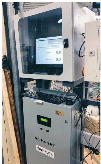
I augusti uppdaterade Nydala Trävaru med fuktmätning, MC Pro 2400. "Nu slinker det inte förbi för blöta bitar".
